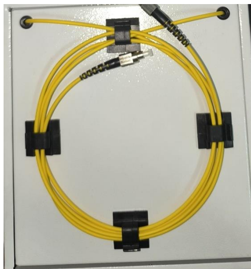
Рисунок 3.1 – Искусственная оптоволоконная линия
